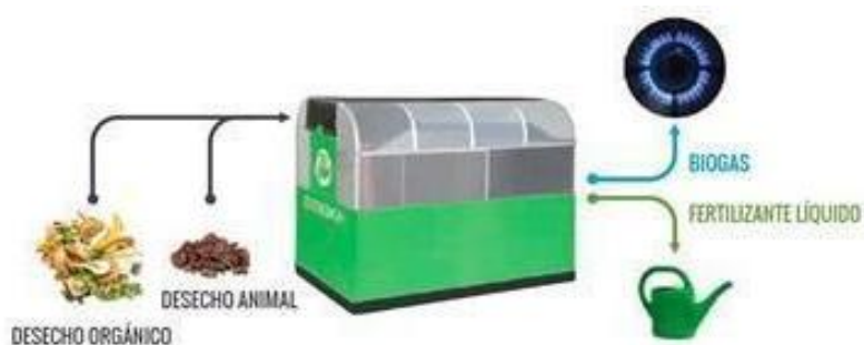
Figura 28: Esquema simplificado de un biodigestor.
