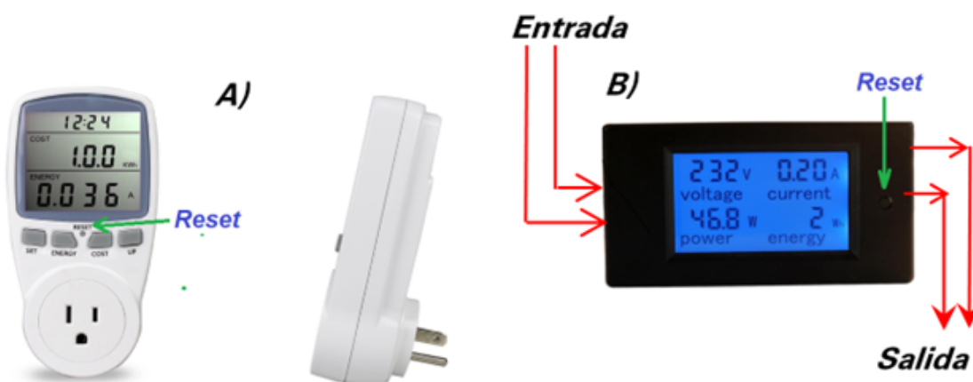
Figura 52. Monitores de consumo, A) modelo con toma incluido en el equipo y B) modelo de monitor con entrada conectada a la red de 220 V y con salida conectada al equipo a medir. Ambos modelos permiten medir simultáneamente la tensión de línea, el consumo en W o kW, corriente y energía después de un cierto tiempo en Wh o kWh.
