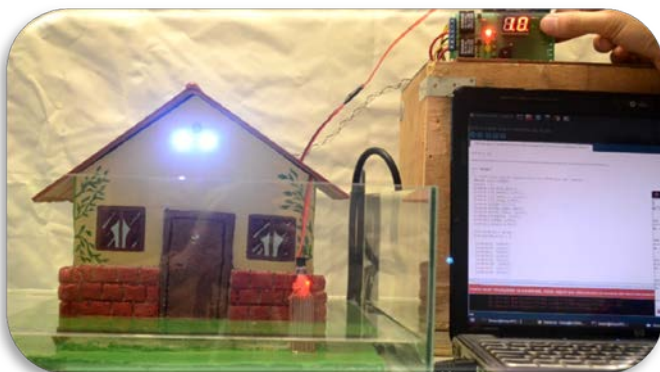
Sensor en nivel rojo, activación de luces de emergencia.
