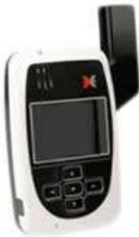
**UNIDAD 2TRACK:** Prácticamente igual a la unidad 2Track que porta el inculcado/condenado, incorpora una antena exterior de radiofrecuencia (RF) que permite detectar la señal de radiofrecuencia del transmisor de RF del inculcado/condenado.
