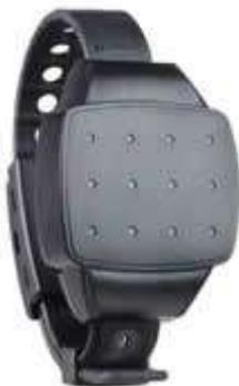
**TRANSMISOR DE RADIOFRECUENCIA (RF):** El transmisor de radiofrecuencia es un brazaletes de pequeñas dimensiones y ligero que emite una señal de radiofrecuencia que es recibida por la unidad 2Track (tanto del propio inculcado/penado como de la víctima), y que incorpora unos sensores que permiten detectar su manipulación o rotura, así como la ausencia de contacto con la piel del usuario.
